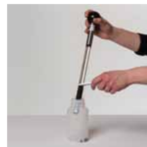
1c) mesure du volume d'échantillon à l'aide de l'échantillonneur gradué (p.ex. sols minéraux)
