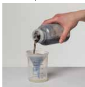
4) Filtration de l'extrait par un filtre rond
