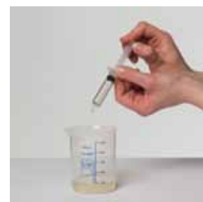
5) Mesure du filtrat par seringue plastique graduée
