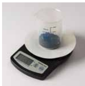
et) pesée de l'échantillon du sol pour indication du taux de nutriments en mg/kg
