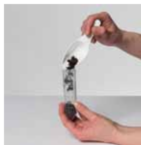
1b) mesure du volume d'échantillon à l'aide du flacon d'échantillon gradué (par ex. substrats de culture jardinière)
