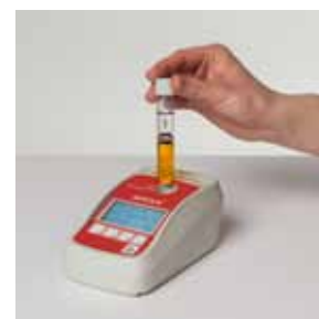
9) Enfichage de la cuvette de mesure dans l'appareil AMOLA® et lecture directe de la valeur de mesure, par exemple, en kg/ha (sols minéraux) ou mg/l (substrat) ou ...
