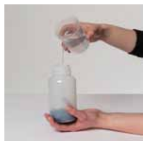
2) Mélange des échantillons avec du produit d'extraction
