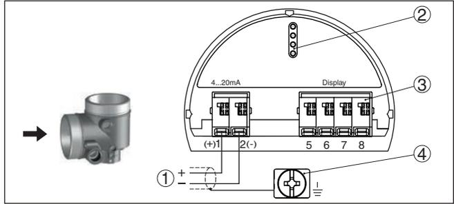
Fig. 24: Compartiment de raccordement - boîtier à deux chambres
