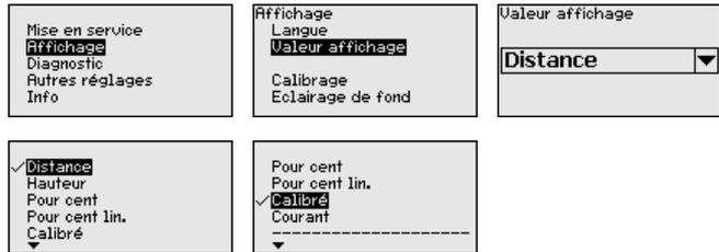
Le réglage d'usine pour la valeur d'affichage est par ex. la distance avec les capteurs radar.
