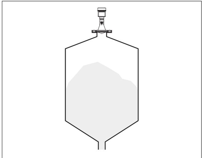
Fig. 2: Montage sur bride du capteur radar
