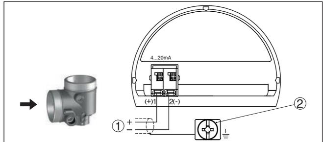
Fig. 27: Compartiment de raccordement - Boîtier à deux chambres Ex-d-ia
