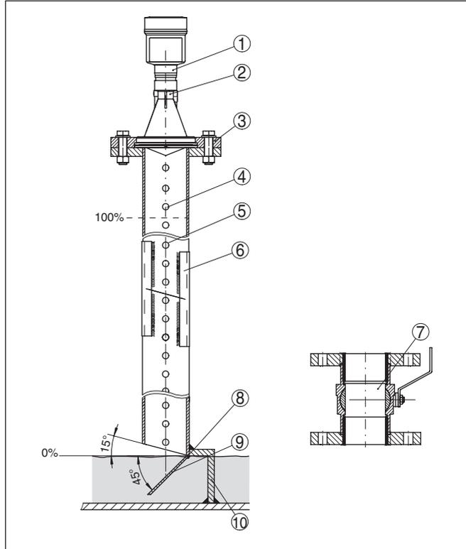
Fig. 16: Structure d'un tube tranquillisateur VEGAPULS 61
