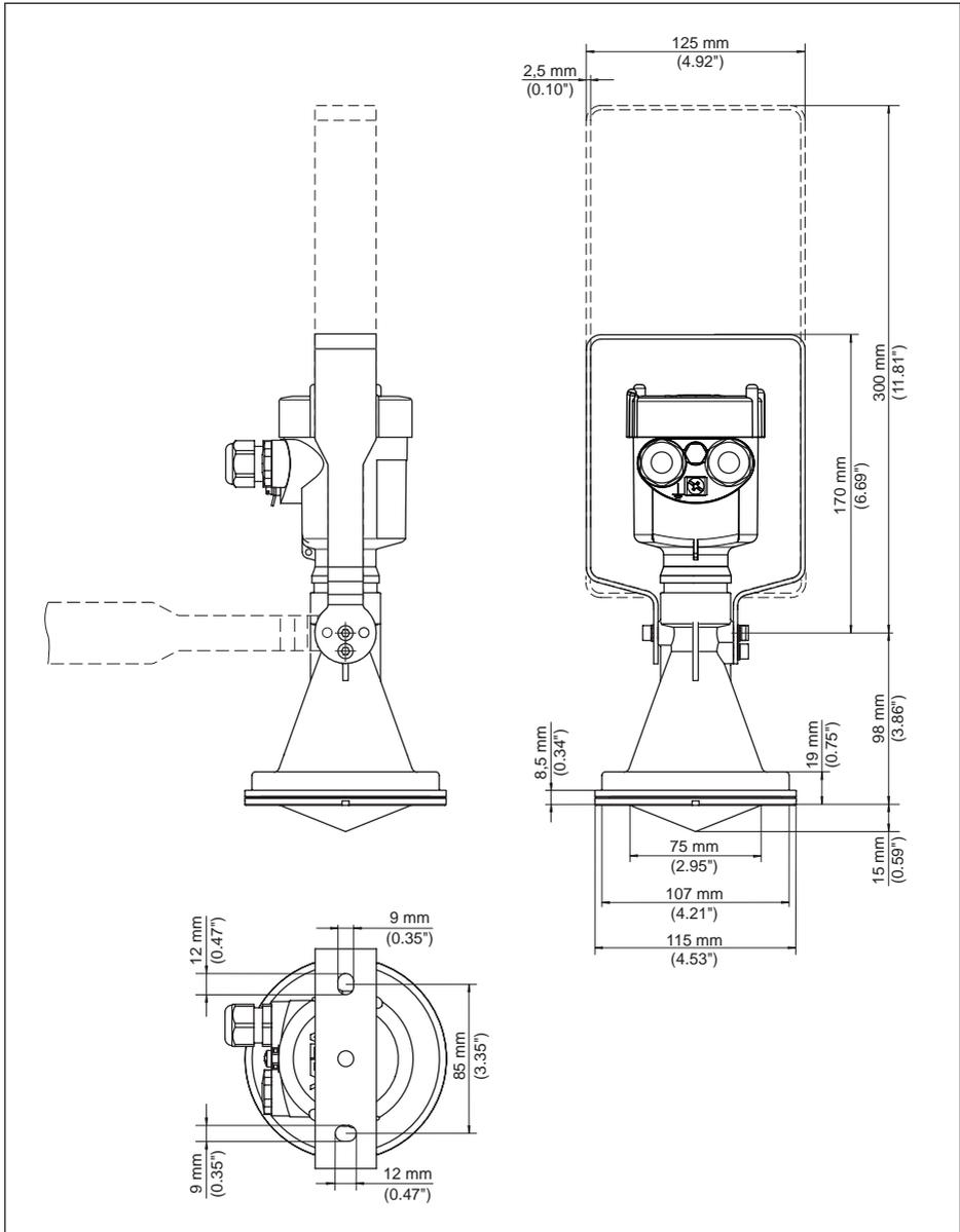
Fig. 65: VEGAPULS 61, étrier de montage en longueur de 170 ou 300 mm
