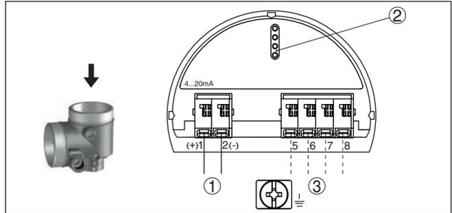
Fig. 26: Compartiment électronique - boîtier à deux chambres Ex-d-ia
