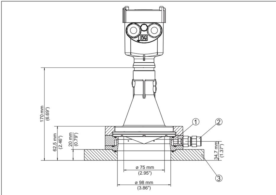
Fig. 71: VEGAPULS 61, Bride d'adaptation avec insufflation d'air
