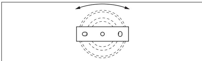
Fig. 4: Pivotement en cas de fixation au centre
