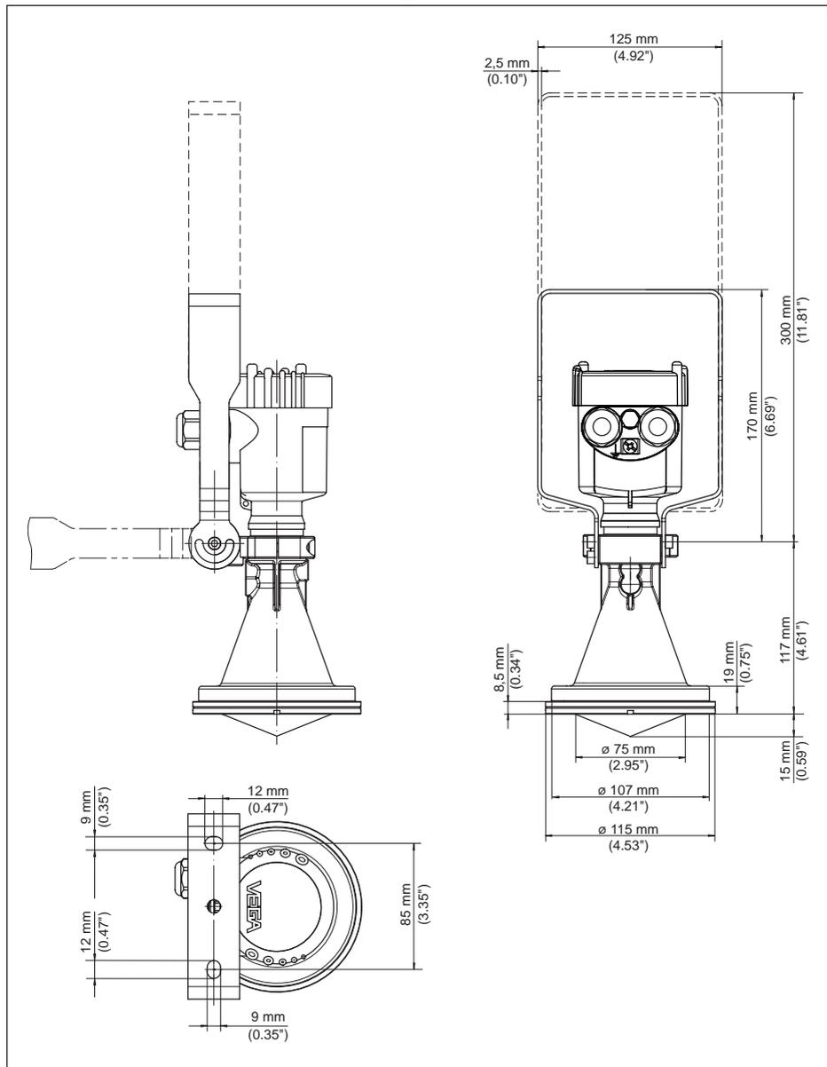
Fig. 66: VEGAPULS 61, étrier de montage en longueur de 170 ou 300 mm
