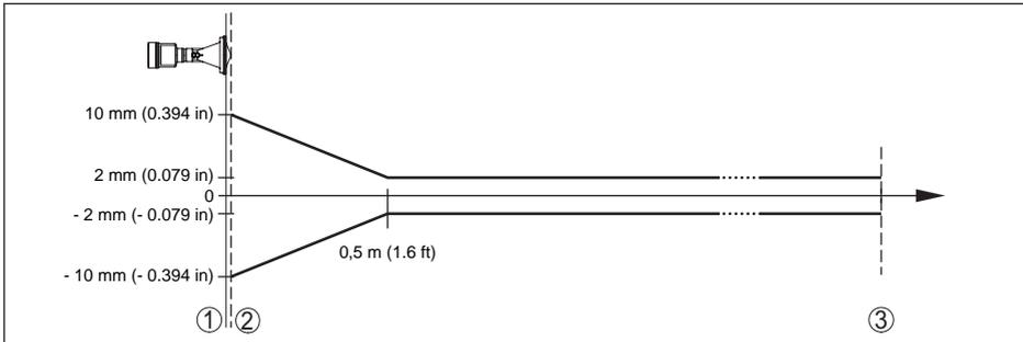
Fig. 57: Écart de mesure sous conditions de référence - antenne cône en plastique
