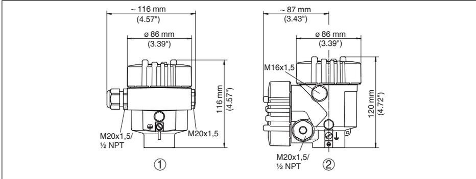
Fig. 59: Variantes de boîtier en protection IP 66/IP 68 (0,2 bar), (avec un module de réglage et d'affichage intégré, la hauteur du boîtier augmente de 18 mm/0.71 in)
