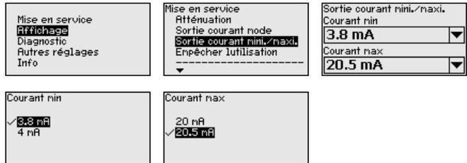
Le réglage d'usine est le courant min. 3,8 mA et le courant max. 20,5 mA.
