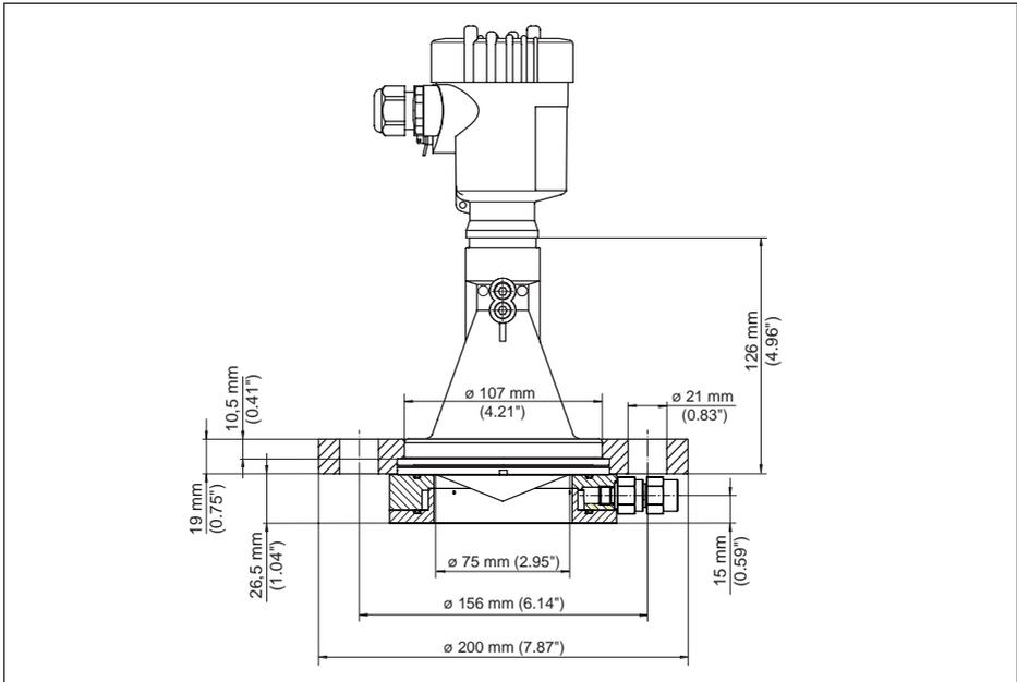
Fig. 69: VEGAPULS 61, bride tournante avec prise de purge, adapté pour DN 80 PN 16, ASME 3" 150lbs, JIS80 10K
