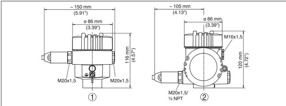
Fig. 60: Variantes de boîtier en protection IP 66/IP 68 (1 bar), (avec un module de réglage et d'affichage intégré, la hauteur du boîtier augmente de 18 mm/0.71 in)
