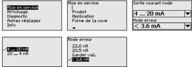
Le réglage d'usine est la courbe caractéristique 4 ... 20 mA, le mode défaut < 3,6 mA.
