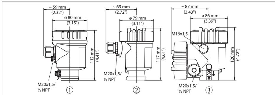
Fig. 61: Variantes de boîtier en protection IP 66/IP 68 (0,2 bar), (avec un module de réglage et d'affichage intégré, la hauteur du boîtier augmente de 18 mm/0.71 in)
