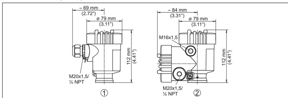
Fig. 58: Variantes de boîtier en protection IP 66/IP 67 (avec un module de réglage et d'affichage intégré, la hauteur du boîtier augmente de 9 mm/0.35 in)
