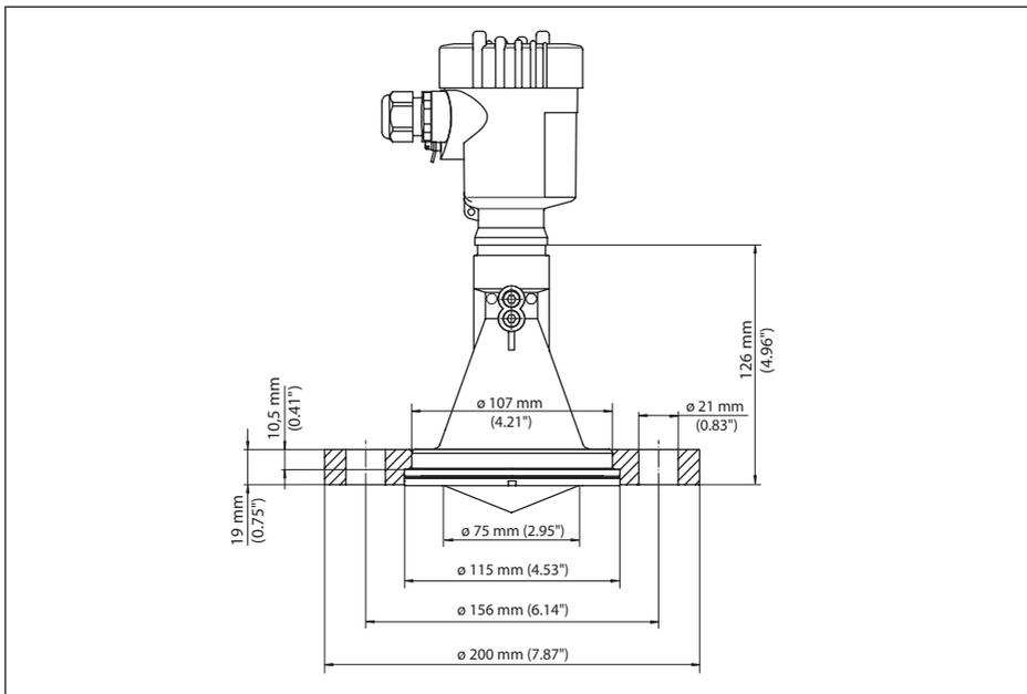
Fig. 68: VEGAPULS 61, bride tournante appropriée au DN 80 PN 16, ASME 3" 150lbs, JIS80 10K
