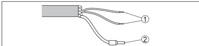
Fig. 31: Affectation des conducteurs câble de raccordement raccordé de façon fixe
