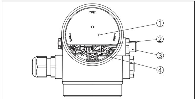
Fig. 29: Vue sur le compartiment de l'électronique avec l'adaptateur VEGADIS pour le raccordement de l'unité de réglage et d'affichage
