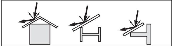
Fig. 14: Recouvrir les obstacles lisses par des déflecteurs
