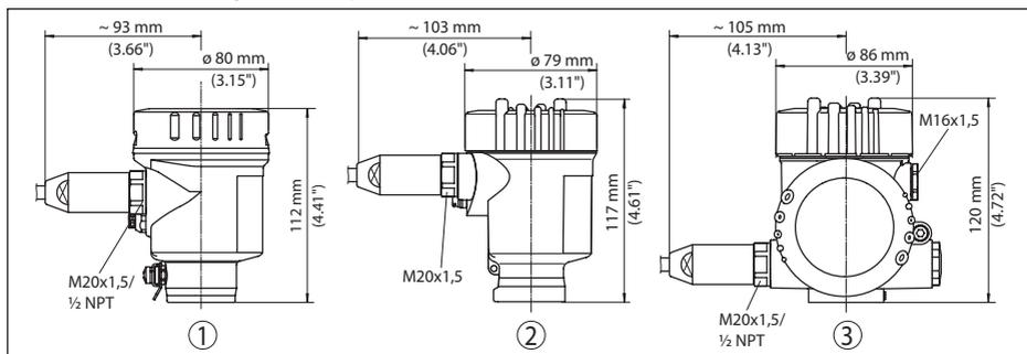
Fig. 62: Variantes de boîtier en protection IP 66/IP 68 (1 bar), (avec un module de réglage et d'affichage intégré, la hauteur du boîtier augmente de 18 mm/0.71 in)
