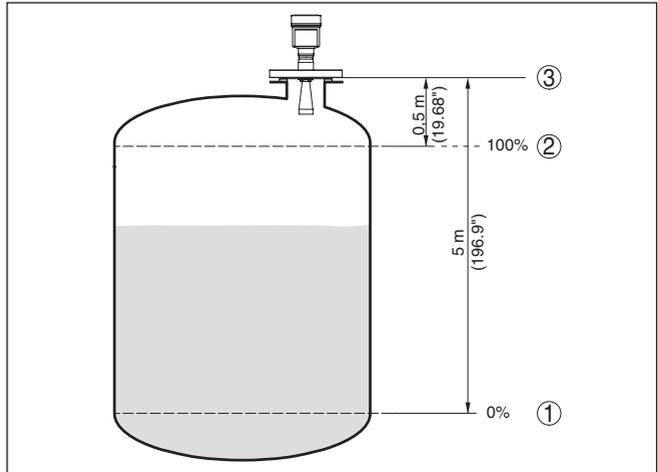
Fig. 36: Exemple de paramétrage réglage min./max.
