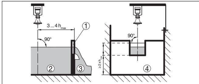
Fig. 19: Mesure de débit avec déversoir rectangulaire :  $d_{\min}$  = écart minimum du capteur (voir chapitre "Caractéristiques techniques") ;  $h_{\max}$  = remplissage max. du déversoir rectangulaire
