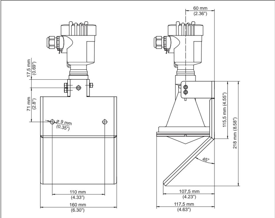
Fig. 67: VEGAPULS 61, étrier de montage et réflecteur
