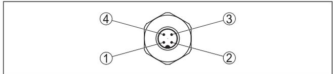
Fig. 30: Vue sur le connecteur M12 x 1
