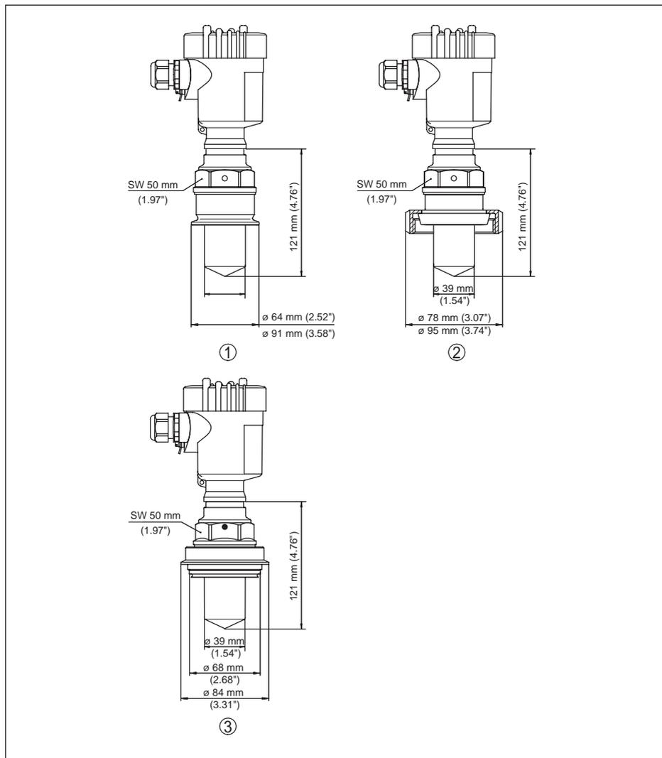
Fig. 64: VEGAPULS 61, raccord aseptique
