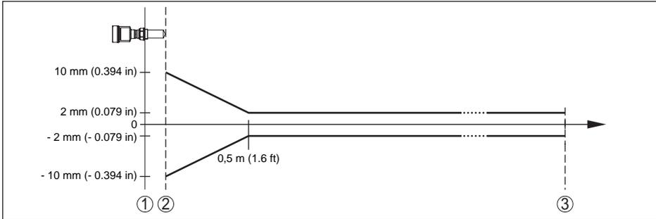
Fig. 56: Écart de mesure sous conditions de référence - système d'antenne encapsulé
