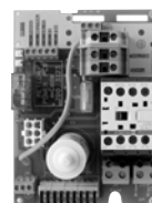
Carte de puissance monophasée "Modèle Froid seul"
