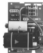
Carte de puissance monophasée "Modèle Froid seul"
